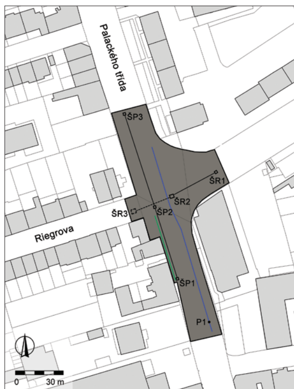
Obr. 4. Brno, Palackého třída. Šedě je podbarvena plocha staveniště, dále jsou vyznačeny linie sledovaných výkopů (černě kanalizace, modře vodovod, zeleně přeložka plynovodu). Archaia Brno z. ú.
