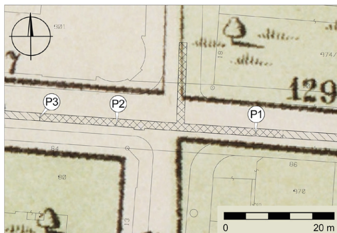
Obr. 5. Brno, Francouzská. Detail křižovatky s Přadláckou ulicí. Vyznačeny dokumentované profily P1, P2, P3. Průběh kanalizace šrafovou; dvojitá šrafová – podrobně sledovaný úsek. Podkreslen plán z roku 1885. (Archiv města Brna, fond U9, signatura K42).
