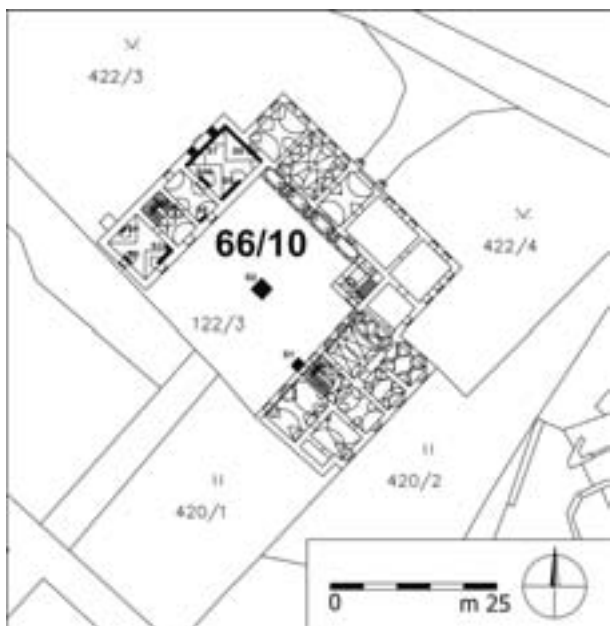
Obr. 9. Brantice. Zaměření zámku s lokalizací jednotlivých sond.
