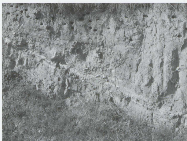
Obr. 28: Pavlov II, spodní část. Stratigrafický profil ve výkopu pro nerealizovanou stavbu. Sesuv redeponovaných terciérních jílu a sutí po ukloněném jílovitém podloží, překrytý spraší. Fig. 28: Pavlov II, lower part. Stratigraphic section in a building site excavation. It shows redeposition of Tertiary silts and debris along the clayish bedrock, covered by loess.
