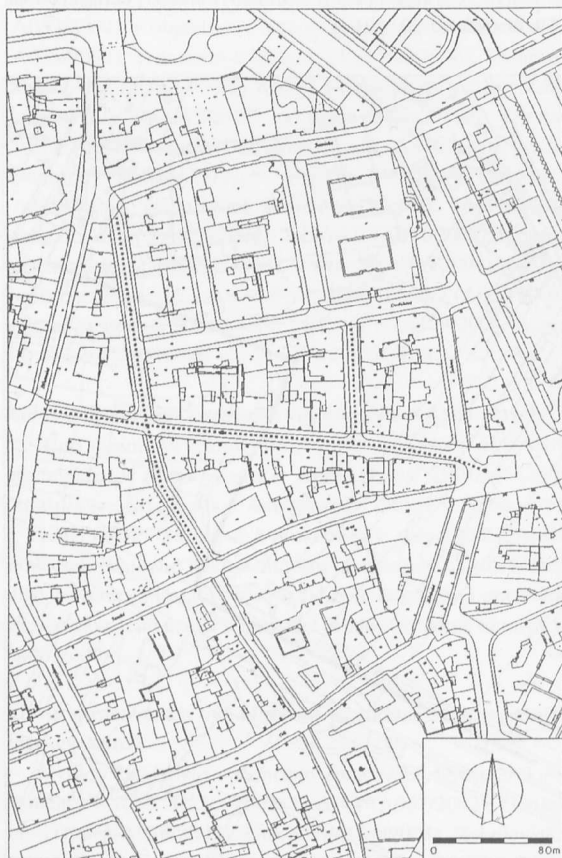
Obr. 4. Dvořákova, Kobližná, Kozí, Poštovská, Sukova (A002/2003). Zachycení hlavních ražeb kolektoru. Dvořákova, Kobližná, Kozí, Poštovská, Sukova (A002/2003). Darstellung der Haupttrassen des Kollektors.
